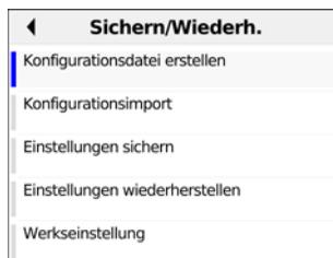
Um eine Konfigurationsdatei im ARGUS erstellen zu können, drücken Sie die Zahnradtaste, um in die Geräteeinstellungen zu gelangen. Wählen Sie nun den Punkt „Sichern/Wiederherstellen“ aus und anschließend „Konfigurationsdatei erstellen“.
