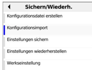
Im ARGUS betätigt man nun die Zahnradtaste, um in die Einstellungen zu gelangen. Dort wählt man „Sichern/Wiederherstellen“ und anschließend „Konfigurationsimport“ aus.
