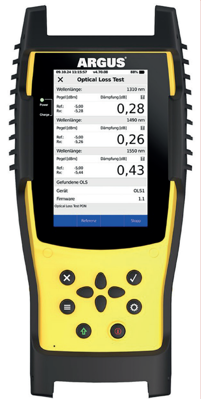
Ergebnisanzeige eines automatisierten Optical Loss Tests als Out-of-Service-Messung über drei Wellenlängen
