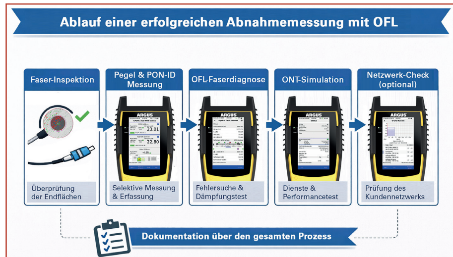
Ablaufdiagramm einer Anschlussabnahme mit Optical Fault Locator und ARGUS F240. So lässt sich die Dämpfung der installierten Strecke bis zum nächsten Splitter eindeutig bestimmen und dokumentieren (Fotos: Intec)
