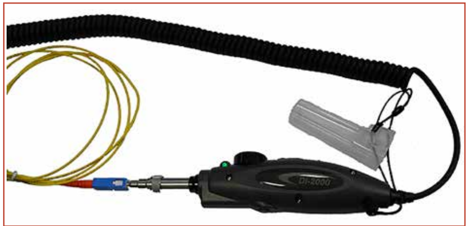
Inspection-Tools sind häufig mit dem Messgerät verbundene USB-Kameramikroskope, die ein hochauflösendes Video-Bild übertragen, das das Messgerät auswerten und per Pass/Fail-Analyse als „gut“ oder „schlecht“ bewerten kann
