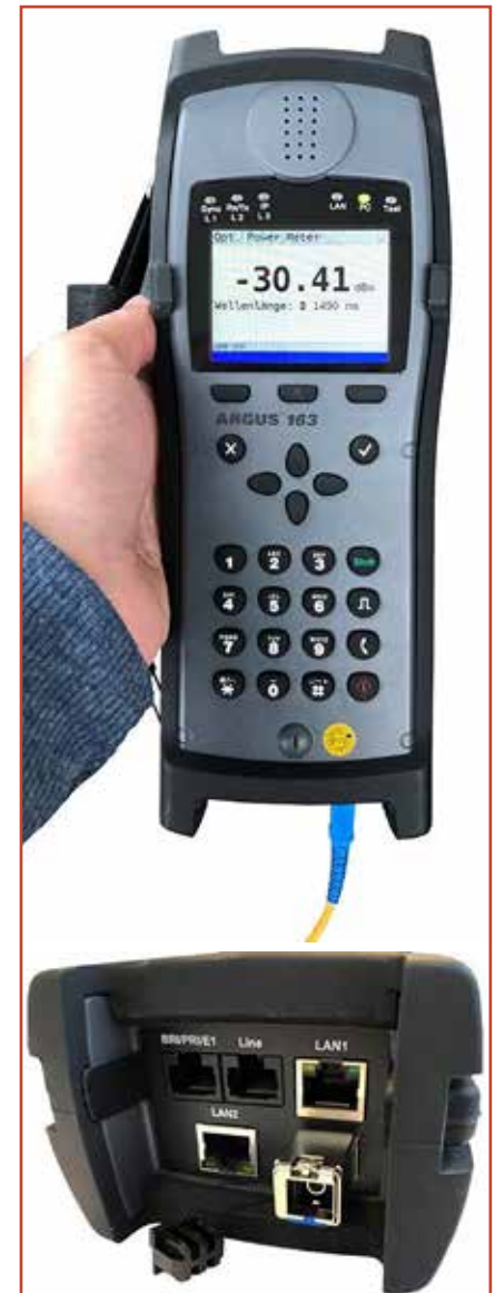
Via SFP-Slot nachgerüstetes Optical Power Meter an einem DSL-Tester. Es misst Wellenlängen zwischen 850 und 1.675 nm von -60 bis 6 dBm, bei 1.310, 1.490 und 1.550 nm und -20 dB mit einer Genauigkeit von \pm 0,25 dB (Fotos: Intec)
