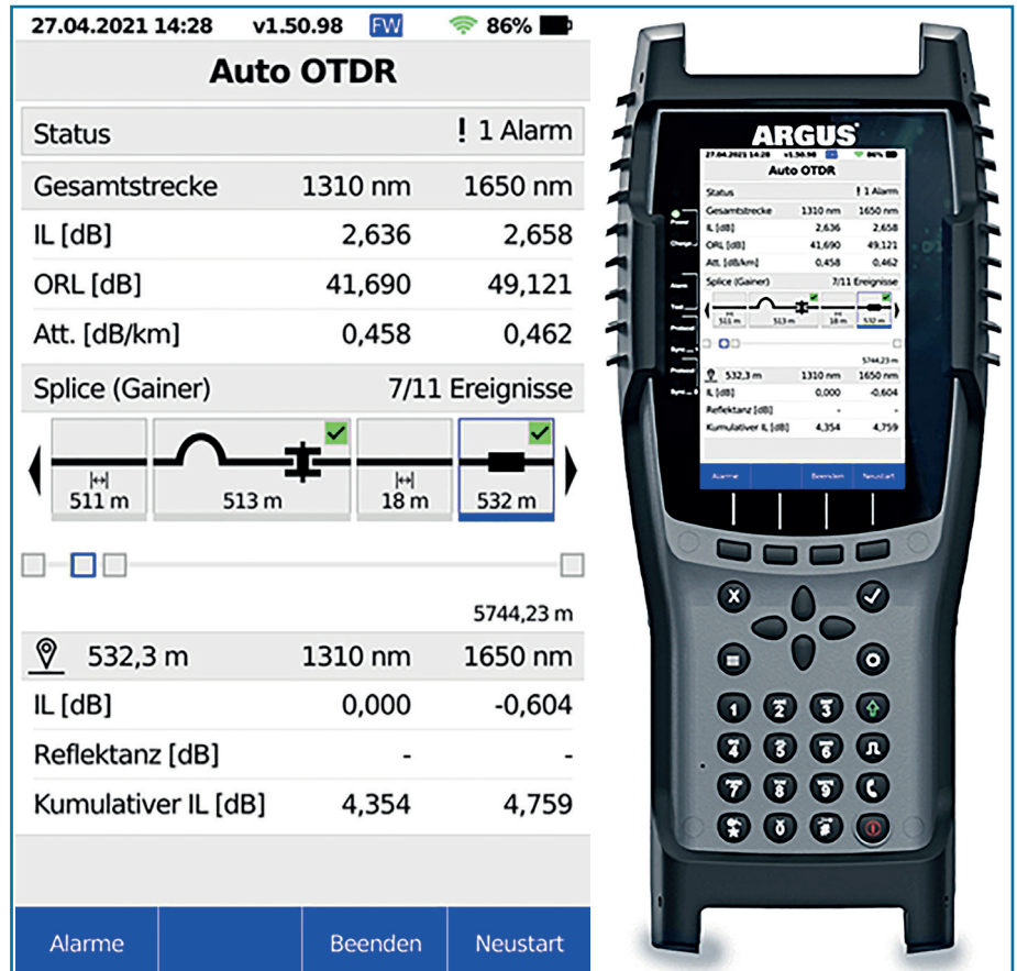
Bild 1: Grafische Event-für-Event-Analyse einer optischen Übertragungsstrecke mithilfe einer OTDR-Messung. Anhand einer Streckengrafik werden Events wie Stecker, Spleiß oder Biegung genau charakterisiert
