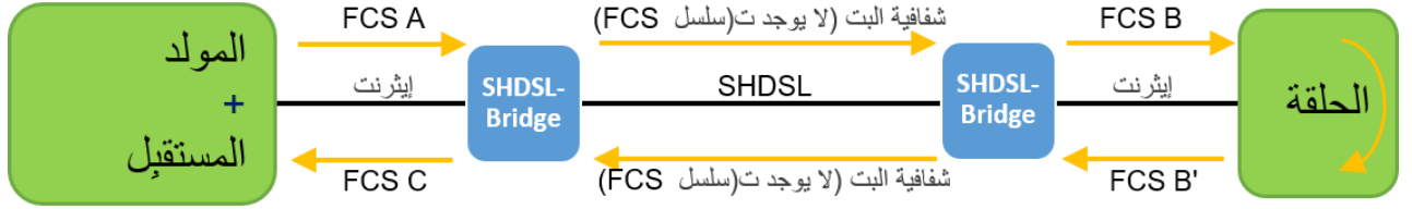
الشكل ٤: إرسال إيثرنت عبر خط ذي شفافية البيت (لا يوجد تسلسل FCS) البتات بدون فحص تسلسل إطار إيثرنت (FCS).
