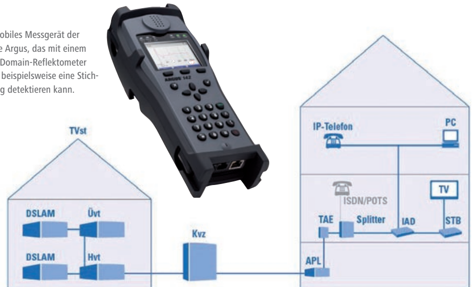
Das Schaubild zeigt den üblichen Aufbau einer TAL, beginnend am DSLAM in der Vermittlungsstelle (TVst) des Netzbetreibers bis hin zum IAD und den Endgeräten wie PC, TV oder Telefon im Kundenhaushalt.
