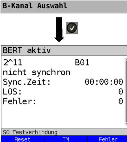
B-Kanal über Tastatur eingeben (zuerst **<Löschen>** drücken) oder mit den Cursortasten einstellen.
