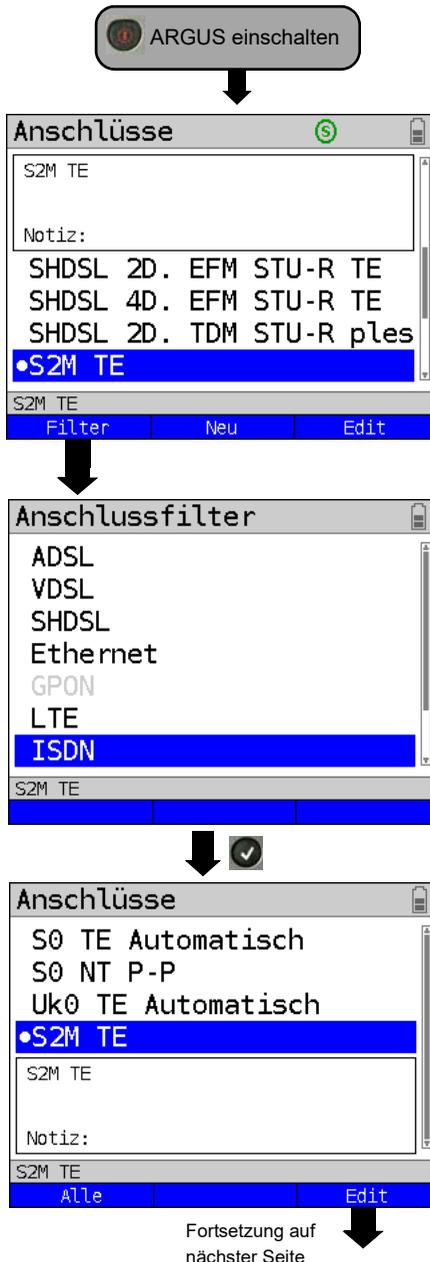
ARGUS zeigt nach dem Einschalten alle konfigurierten Anschlüsse (bis zu 100 Stück) an. Defaultmäßig ist für jeden Anschlussstyp ein Anschluss vorkonfiguriert.
