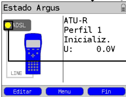
El ARGUS se sincroniza con el DSLAM (el LED "Sync/L1" parpadea y en la pantalla se muestra un LED amarillo). El ARGUS indica el estado de conexión actual (en este caso Inicializ.).
