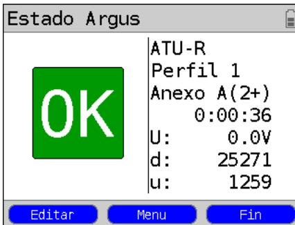
Establecer la conexión xDSL o Ethernet. El perfil mostrado en la pantalla (en este caso perfil 1) se utiliza para la descarga HTTP.
