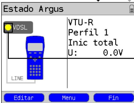
El ARGUS se sincroniza con el DSLAM (el LED "Sync/L1" parpadea y en la pantalla se muestra un LED amarillo). El ARGUS indica el estado de conexión actual (en este caso "Inic total").
