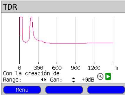
El ARGUS muestra directamente los posibles puntos de interferencia en la línea de cobre de 2 hilos.
