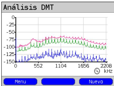
En el caso de una interferencia permanente (ver pantalla de ejemplo), podría suponerse, por ejemplo, una fuente de alimentación defectuosa acoplada a la línea vacía.
