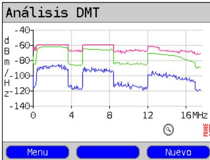
Como ejemplo (ver imagen), es posible detectar así las diferentes bandas de upstream y downstream de una conexión VDSL2 existente.
