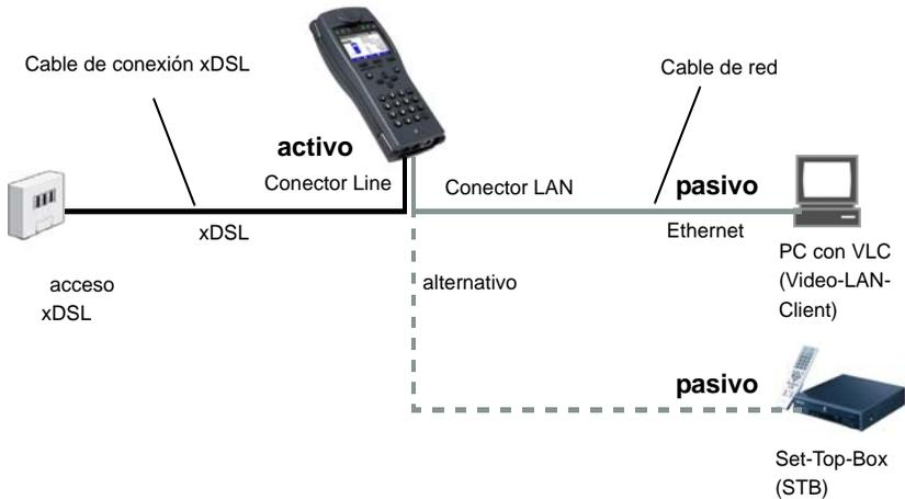
Para realizar el análisis MDI se necesitan los siguientes ajustes memorizados en el perfil (si la conexión xDSL o Ethernet ya se ha establecido, los parámetros de acceso, p. ej. el modo ADSL y el valor teórico, están bloqueados):
