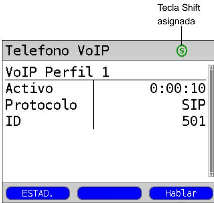
El ARGUS muestra el perfil VoIP utilizado, el protocolo y la identificación de usuario (ID, "número propio"). Si se utiliza un Registrar, el ARGUS muestra la duración del registro realizado.
