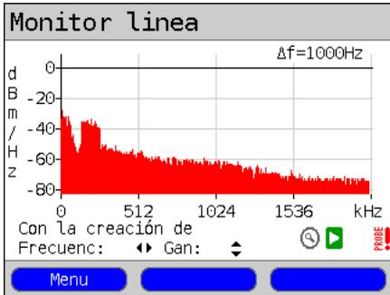
Con el monitor de línea se pueden examinar diferentes estados o resultados en la línea de conexión. En el ejemplo puede verse la conexión ADSL (anexo B) establecida entre el modem y el DSLAM con RDSI-U. El monitor de línea se encuentra cerca del modem, dado que el upstream en el espectro destaca especialmente. Si el upstream fuese considerablemente menor que el downstream, esto indicaría que el ARGUS se encuentra cerca del DSLAM.
