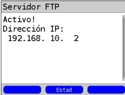
El ARGUS utiliza la dirección IP configurada en "dirección IP local" como dirección de destino (servidor) para el segundo ARGUS.
