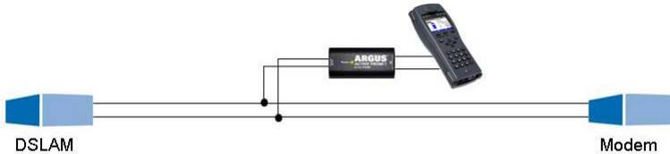
En este modo es posible detectar señales activas (p. ej. del modem o DSLAM) en una conexión existente. Así pueden rastrearse las interferencias de banda ancha que sobrepasan las señales activas.
