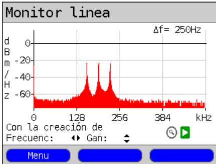
Además de determinar el estado general de la línea / la conexión, también se pueden detectar diferentes resultados. Por ejemplo, se pueden ver las señales piloto iniciadas por el modem que un modem conectado a la línea envía periódicamente para establecer una conexión con el DSLAM. De este modo se puede detectar también si hay un modem activo conectado al otro extremo de la línea o no.
